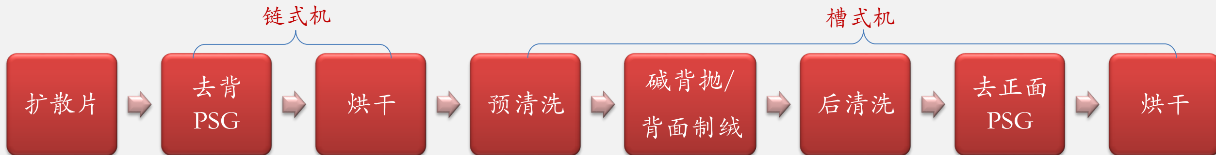
方案2：链式去背面PSG+槽式碱抛光机
